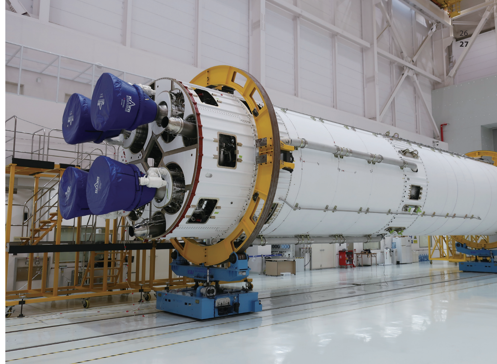
우리나라가 순수 국내 기술을 적용해 개발 중인 한국형 우주발사체 '누리호' 1단 발사체 인증모델 모습. ©KARI The first-stage QM of Korean space launch vehicle Nuri, being developed with domestic technologies
